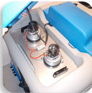
motore di aspirazione molto potente e facilmente accessibile very powerful and easily accessible suction motor
